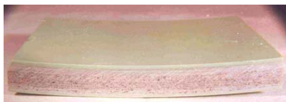
Image 1 Stratifié sandwich avec âme en bois de balsa
