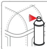
Vaporiser une couche d'Apprêt de Finition. Poncer avant d'appliquer une peinture compatible avec le type de support
