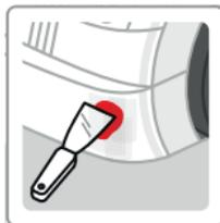
Enduire la réparation de Mastic de Finition à l'aide d'une spatule. Laisser durcir 15-20 minutes, puis poncer. Appliquer l'Apprêt de Finition, poncer, puis procéder ensuite aux travaux de peinture.
