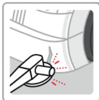
Dégraisser la zone à réparer. Poncer ou disquer la zone enfoncée et fendue.
