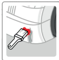
Appliquer 1 couche de résine, puis un morceau de Mat de Verre, qui ne doit pas recouvrir complètement la zone à réparer. Imprégner de résine jusqu'à transparence du mat.
