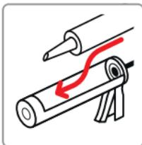
Couper l'embout de la cartouche et adapter la buse. Avant de l'insérer dans le pistolet, retirer l'opercule en aluminium en fond de cartouche, ainsi que le sachet pour l'humidité qu'elle contient.
