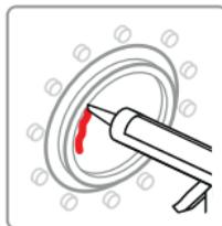
Extruder le mastic tout en l'appliquant sur l'emplacement où l'étanchéité est à refaire.
