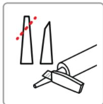
Couper la pointe de la buse (fournie avec la cartouche) en biseau, à la dimension de la largeur du cordon à extruder.
