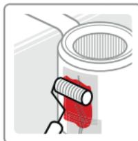
Appliquer le Mat de Verre, l'imprégner de résine jusqu'à parfaite transparence. Répéter 3 fois l'opération, couches mouillé sur mouillé. Après durcissement, poncer et appliquer 3 autres couches de mat intercalées avec le Tissu de Verre.
