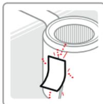
Avec l'abrasif P40, créer une légère cuvette autour de la zone à réparer.
