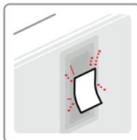
Poncer au bout de 4-5 h de séchage avec un abrasif P40 ou P80
