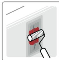
Appliquer le plus petit bout de Mat de Verre, l'imprégner de résine jusqu'à parfaite transparence. Répéter le process par taille croissante, mouillé sur mouillé.
