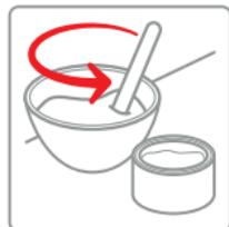
Mélanger la résine à 2-3% de durcisseur P MEC. Poncer à l'abrasif P40 la zone à réparer. Préparer 3 couches de Mat de Verre, de tailles croissantes
