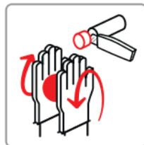
Enfiler des gants de protection, prélever la masse nécessaire de Pâte Epoxy Haute Température, et malaxer jusqu'à obtention d'une couleur uniforme. A utiliser dans les 3-4 minutes.
