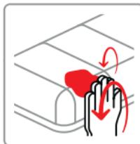
Lisser avec un doigt ganté et mouillé avant durcissement.
