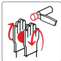
Enfiler des gants de protection, prélever la masse nécessaire de Pâte Epoxy Marine, et malaxer jusqu'à obtention d'une couleur uniforme. A utiliser dans les 5-10 minutes.
