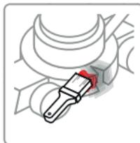
Renouveler l'opération, mouillé sur mouillé, en superposant, tout en les décalant, les bouts de mat, jusqu'à recouvrir entièrement la zone à réparer, pour une meilleure accroche. Laisser durcir 6-8 h avant de poncer.
