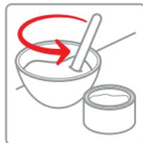
Résine: 100 g de résine pour 60 g de durcisseur, ou en volume : 100 parts pour 70 parts
