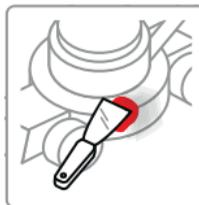
Pour la finition, enduire la réparation de Mastic de Finition à l'aide d'une spatule. Laisser durcir 15-20 minutes, puis poncer. Appliquer l'Aprêt de Finition, poncer, puis procéder ensuite aux travaux de peinture.
