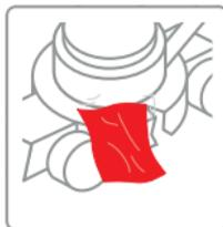
Dégraissier la zone à réparer à l'aide d'un chiffon. Poncer.
