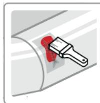
Appliquer 1 couche de Mat de Verre ou de Tissu de Verre 300g/m<sup>2</sup>. L'imprégner de résine jusqu'à parfaite transparence. Renouveler l'opération autant que nécessaire, mouillé sur mouillé.
