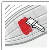
Laisser durcir 12h, poncer si nécessaire avec abrasif P120. Appliquer 3 couches de résine, en laissant sécher entre chacune.
