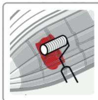
Appliquer le Tissu de Verre, imprégner de résine jusqu'à parfaite transparence avec le rouleau. Veiller à bien éliminer les bulles d'air. Renouveler l'opération, mouillé sur mouillé.
