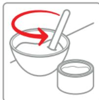
Mélanger la résine au durcisseur. Dosage: 45g de durcisseur pour 100g de résine, ou 49 parts de durcisseur pour 100 parts de résine;
